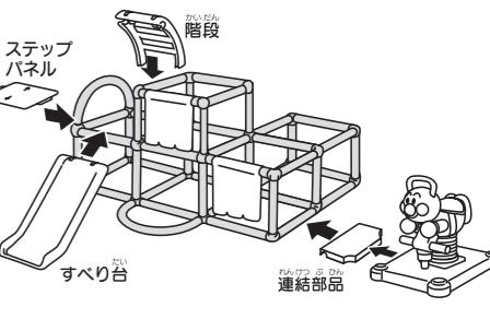
※ステップパネルは、すべり台と階段をセットした後にセットしてください。
