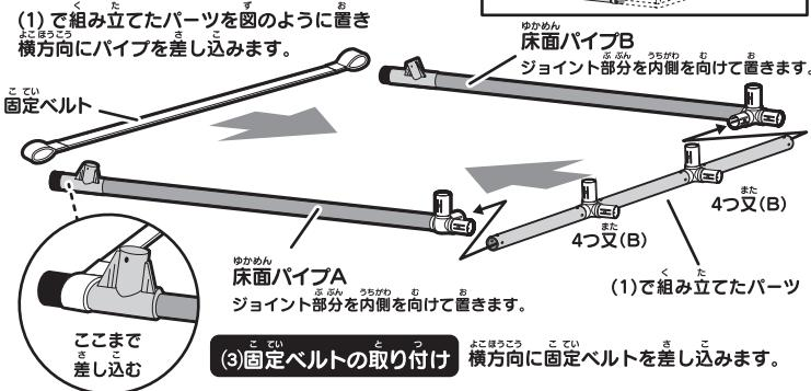
**2** ジム部の床面を組み立てます。はじめに縦方向のジョイントにパイプを差し込みます。次に、横方向のジョイントにパイプを差し込みます。
