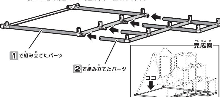
**4** 1段目上部を組み立てます。はじめに縦方向のジョイントにパイプを差し込みます。次に、横方向のジョイントにパイプを差し込みます。
