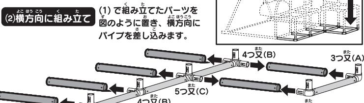
**3** 1と2で組み立てたパートを図のように差し込みます。
