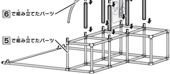
8 3段目上部を組み立てます。はじめに、支柱板Bをパイプに通します。次に、縦方向のジョイントにパイプを差し込みます。最後に横方向のジョイントにパイプを差し込みます。
