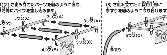
(1)(2)で組み立てたパートを図のように置き、横方向にパイプを差し込みます。
