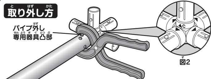
ジョイントの凸部とパイプ穴が接続されているパイプ穴2ヶ所にパイプ外し専用器具の凸部が当たるようにセットします。
