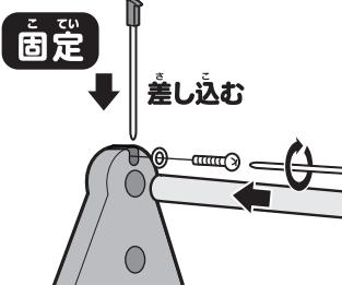
「20ピス(ワッシャー付)透明の袋入り」の取り付けは、プラスドライバーでしっかりと締めてください。
