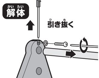
「20ピス(ワッシャー付)透明の袋入り」の取り付けは、プラスドライバーでしっかりと締めてください。
