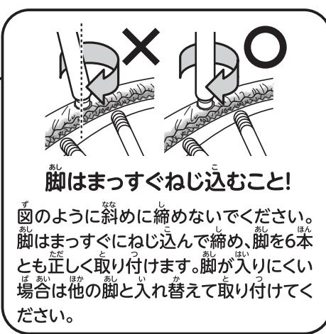
付属の脚6本を本体に取り付けます。脚を時計回りに止まる所まで回し、しっかり締めてください。
