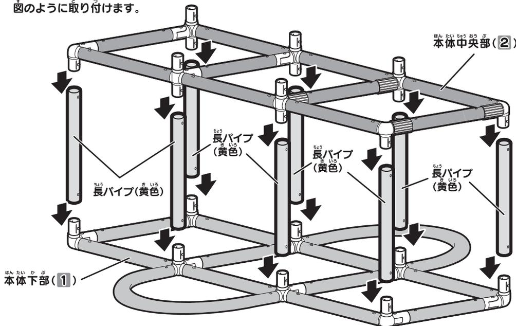
※①②で組み立てたパーツの折り曲げ方向が同じか確認して組み立ててください。
