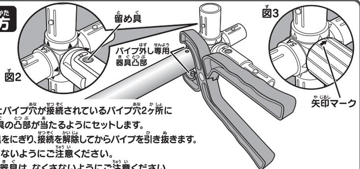
ジョイントの凸部とパイプ穴が接続されているパイプ穴2ヶ所にパイプ外し専用器具の凸部が当たるようにセットします。
