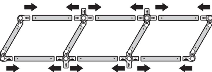
★折り曲げジョイント部には、必ず短パイプが接続され、折り曲げられないジョイント部には長パイプもしくはその他のパーツが接続されます。
