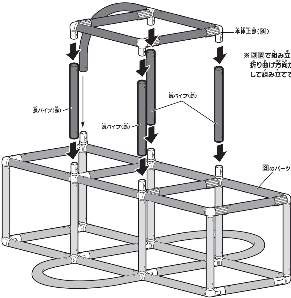
※③④で組み立てたパーツの折り曲げ方向が同じか確認して組み立ててください。
