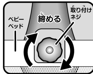
取り付けネジをゆるめてベッドの枠に取り付け、取り付けネジが「カチッ」と鳴るまで回してしっかりと締めて固定します。
