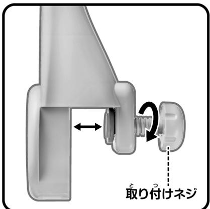
①取り付けネジを矢印の方向に回し、隙間を作ります。
