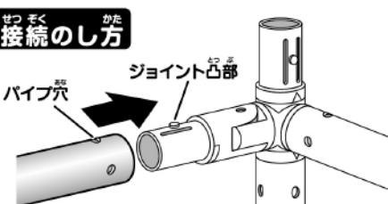
ジョイントの凸部2ヶ所と、パイプに空いた4つの穴のうちの2ヶ所をしっかりと差し込み、パイプ穴にジョイント凸部がはまっていることを確認してください。
