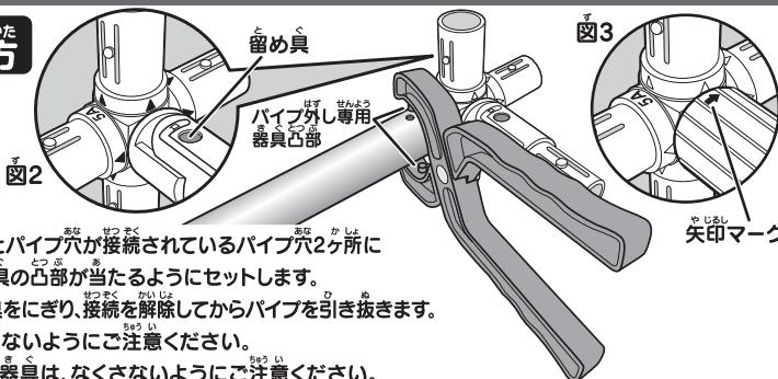
ジョイントの凸部とパイプ穴が接続されているパイプ穴2ヶ所にパイプ外し専用器具の凸部が当たるようにセットします。
