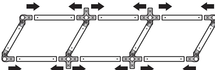
★折り曲げジョイント部には、必ず短パイプが接続され、折り曲がらないジョイント部には長パイプもしくはその他のパートが接続されます。
